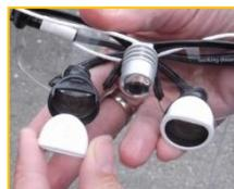
Setzen Sie den neuen Varioclip zuerst an der Unterseite des Okulars (grau/schwarz) an.
