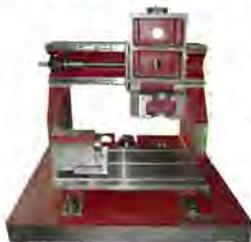
Eine massive Guss-Unterkonstruktion, schwere LM Kugelumlauf Führungen, sehr genaue und große Kugelrollspindel, A&B Achsen mit HarmonicDrive Getriebe und max. LMF Abstand garantieren lange Lebensdauer. Starke Antriebssysteme von Yaskawa und eine hochdynamische CNC Steuerung garantieren homogene und schnelle Bewegungen aller Achsen.
