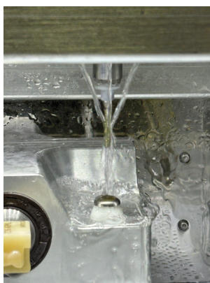
Optimale Kühlung mit 3 Spezialdüsen
