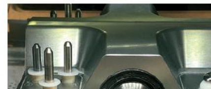
Abb. 1 und 2: Die neue kompakte EASY Mill 4-Schleifeinheit von orangedental arbeitet mit Wasserkühlung.
